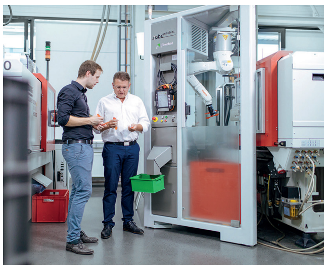
Bild 2. Matthias Gindele (r.), Geschäftsführer der Gindele GmbH, und Manuel Habermann (l.) von robomotion prüfen die Bauteilqualität. Die Roboterzelle daneben ist schlank genug, um sie in unmittelbarer Nähe zur Spritzgießmaschine zu positionieren (© Kuka)
